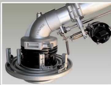
Nuovo Rotorkit Slideway a 1-2 timer, di uso facile e preciso. I morsetti di fermo settore sono posizionati su 3 guide scorrevoli e permettono sino a 3 angoli diversi d'irrigazione, con ampiezza a scelta. Il sistema permette l'irrigazione di terreni di varia forma o con ostacoli interni (case, capannoni), garantendo risparmio d'acqua.
