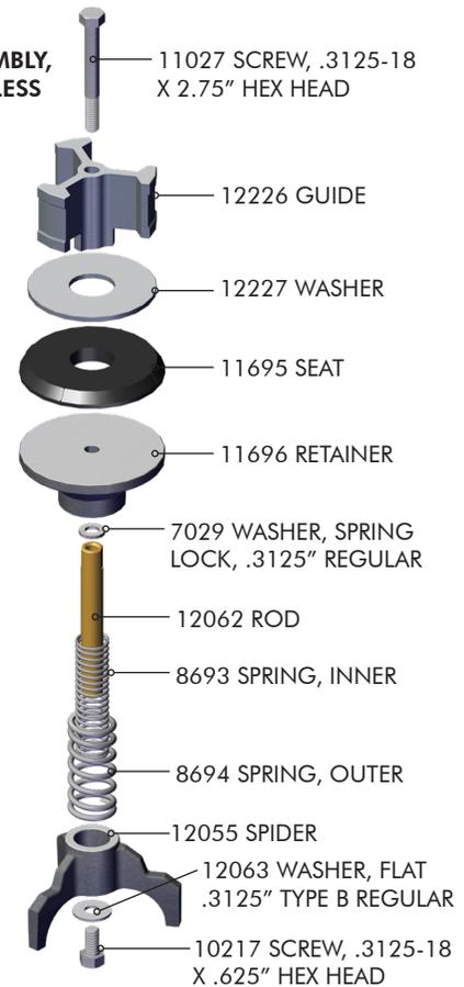
**LOWER PILOT LINE CONNECTOR ASSEMBLY 8697**
